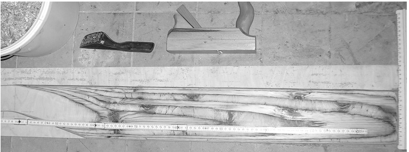
Das Vollholzruder nach der Profilierung, zwischen die Abschnitte der Sperrholzplatte gelegt; zur Profilierung benutzte Werkzeuge
