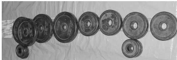
Das Laminatruder wird zur Verklebung der einzelnen Sperrholzlagen gleichmäßig auf einer ebenen Unterlage beschwert (Gewichte eines Hantelsatzes)
