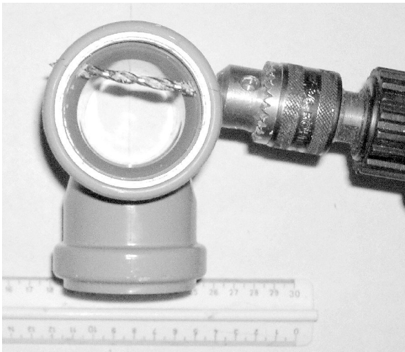
Vorsichtiges Aufbohren der 3 mm - Vorbohrung im Mastkopf mit einem 5 mm-Bohrer im richtigen Winkel
