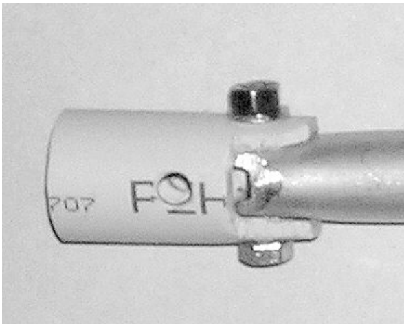
Kardangeln mit Verbindung zum oberen Segment der Schubstange.
