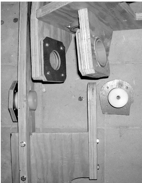
Servolager vor der Montage. Der Servolagerträger wird mit den Lagerrollen und den 4 mm Abstandsringen am Gehäuse montiert.
