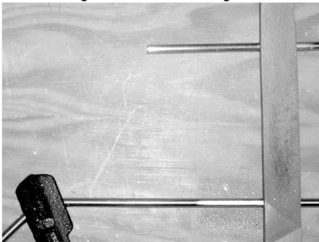
Präzises Feilen des Drehschaftes mit einem Stück Edelstahlstange als „Rollenlager“ für die Metallfeile
