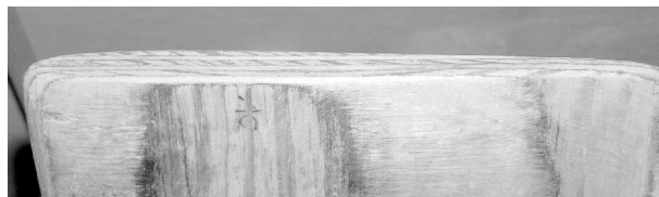
Unteres Ende des Vollholzruders: Profil ähnlich einer Flugzeugtragfläche, an der dicksten Stelle 10 mm.
